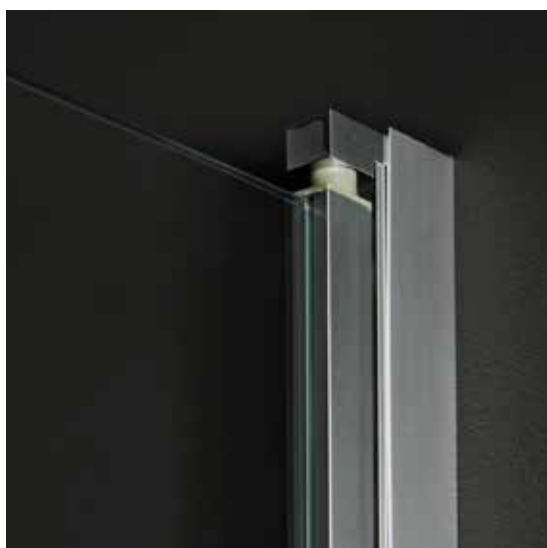
Duschhörn med stabila lyftgångjärn som lyfter dörrarna 3 mm vid öppning och stängning. Limbara profiler i matt aluminium.
