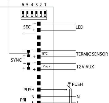
Kraftfull allt-i-ett-konverter för LED med inbyggd PWM-dimmer. Klarar med en enkel inställning att driva och ljusreglera de flesta typer av LED-ljuskällor, både konstantspänning DC (48V) och konstantström DC (350, 500, 550, 650, 700, 750, 850, 900, och 1050 mA). 1-10st enheter kan länkas och styras från ett eller flera ställen via återfjädrande tryckknapp, via potentiometer, 1-10V eller bus-/KNX-system via aktor. Levereras med synkkabel 15cm.
