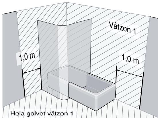
Skruvinfästning i våtzon 1 ska göras i massiv konstruktion såsom betong, reglar, särskild konstruktionsdetalj eller i Våtrumsvägg 2012.
